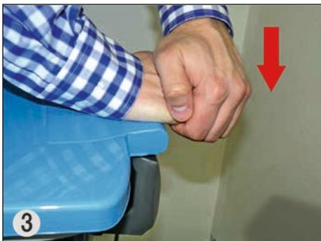
3. Zum Schluss Deckel bis zum Einrasten auf das Scharnierunterteil drücken und Schubstange anschließend wieder auf das Pedal rasten lassen.
